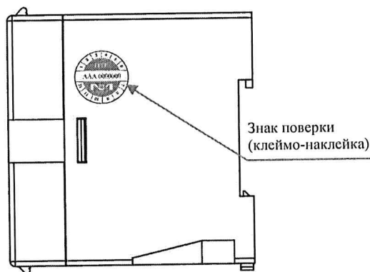
Рисунок 2.1 – Схема с указанием места для нанесения знака поверки на преобразователи в корпусах М6, М8
