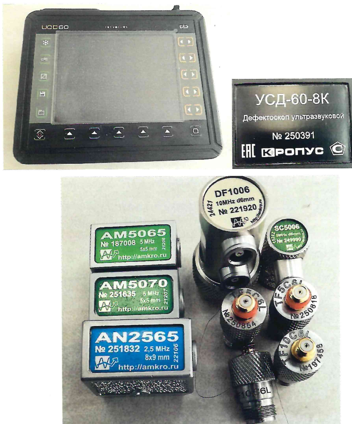
Рисунок 1.1 – Фотографии общего вида и маркировки дефектоскопа ультразвукового УСД-60-8К, № 250391 (электронный блок и преобразователи ультразвуковые)
