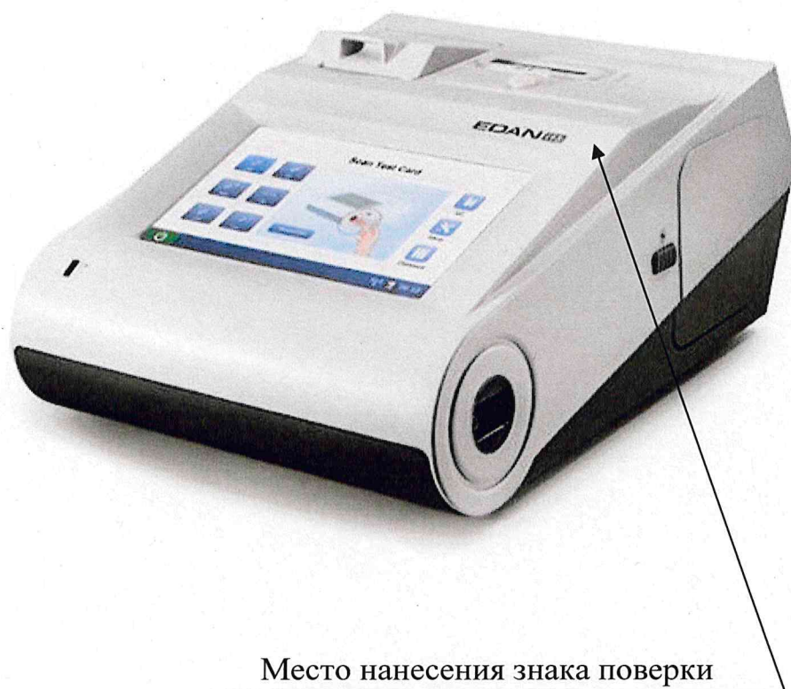
Рисунок 2 – Схема с указанием места для нанесения знака поверки на анализатор газов и биохимического состава крови i15 № 960360-M21202920016
