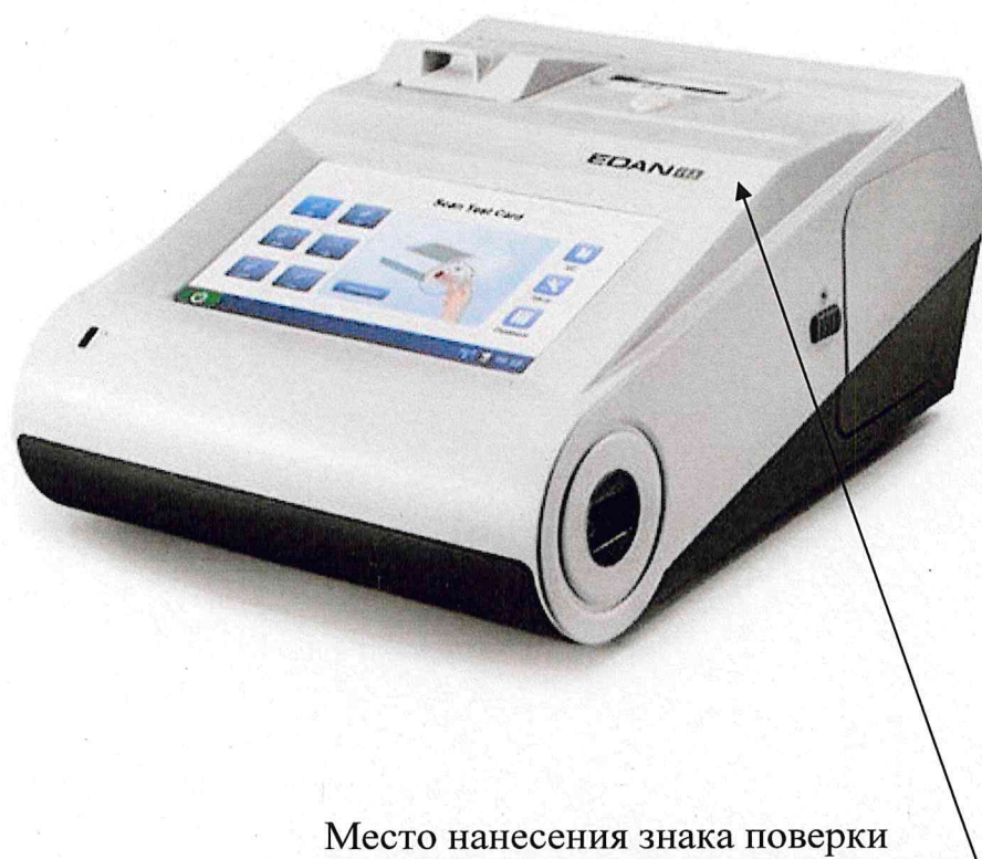
Рисунок 2 – Схема с указанием места для нанесения знака поверки на анализатор газов и биохимического состава крови i15 № 960360-M22413130007
