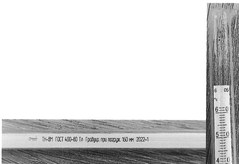
Рисунок 1.2 – Фотография маркировки термометра стеклянного для испытаний нефтепродуктов ТН-8М, № 605
