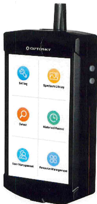
Рисунок 1.1 – Фотографии общего вида анализатора рамановского портативного ATR6500, № 261027XXH2X02543
