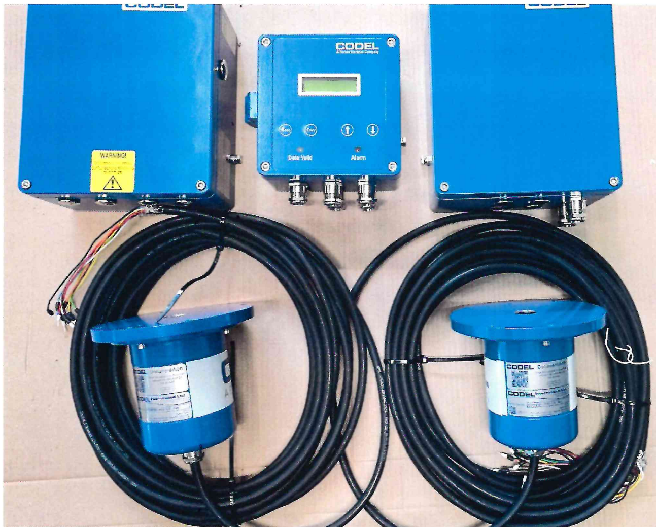
Рисунок 1.1 – Фотография общего вида. Измеритель скорости газовоздушных потоков VCEM5100 № VCEM5100 – 1139 TUV SPU
