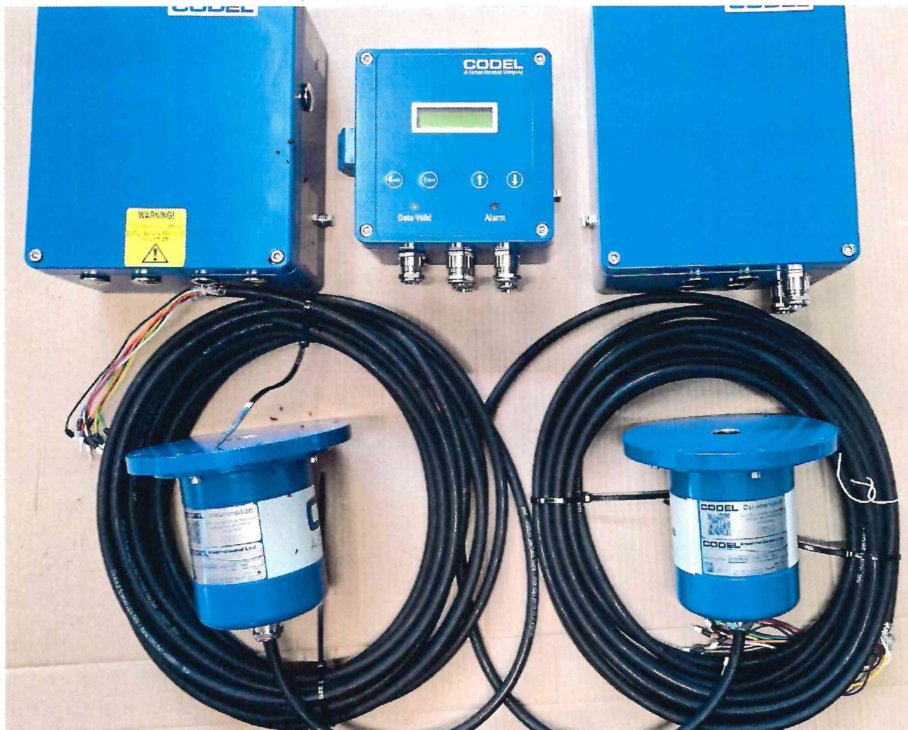
Рисунок 1.1 – Фотография общего вида. Измеритель скорости газоздушных потоков VC5M5100 № VC5M5100 – 1134 TUV SPU
