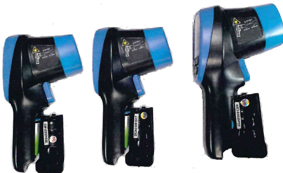
Рисунок 1.4 – Фотографии маркировки пирометров НАДЗЕЙНЫ ЭП модификации ЭП-550 (изображение носит иллюстративный характер)
