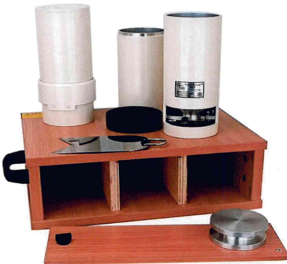
Рисунок 1.1 - Внешний вид пурки литровой рабочей с падающим грузом ПХ-2 № 1910
