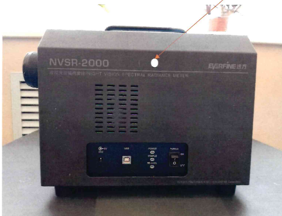
Рисунок 2.1 – Фотография с указанием места для нанесения знака поверки спектрорадиометра NVSR-2000
