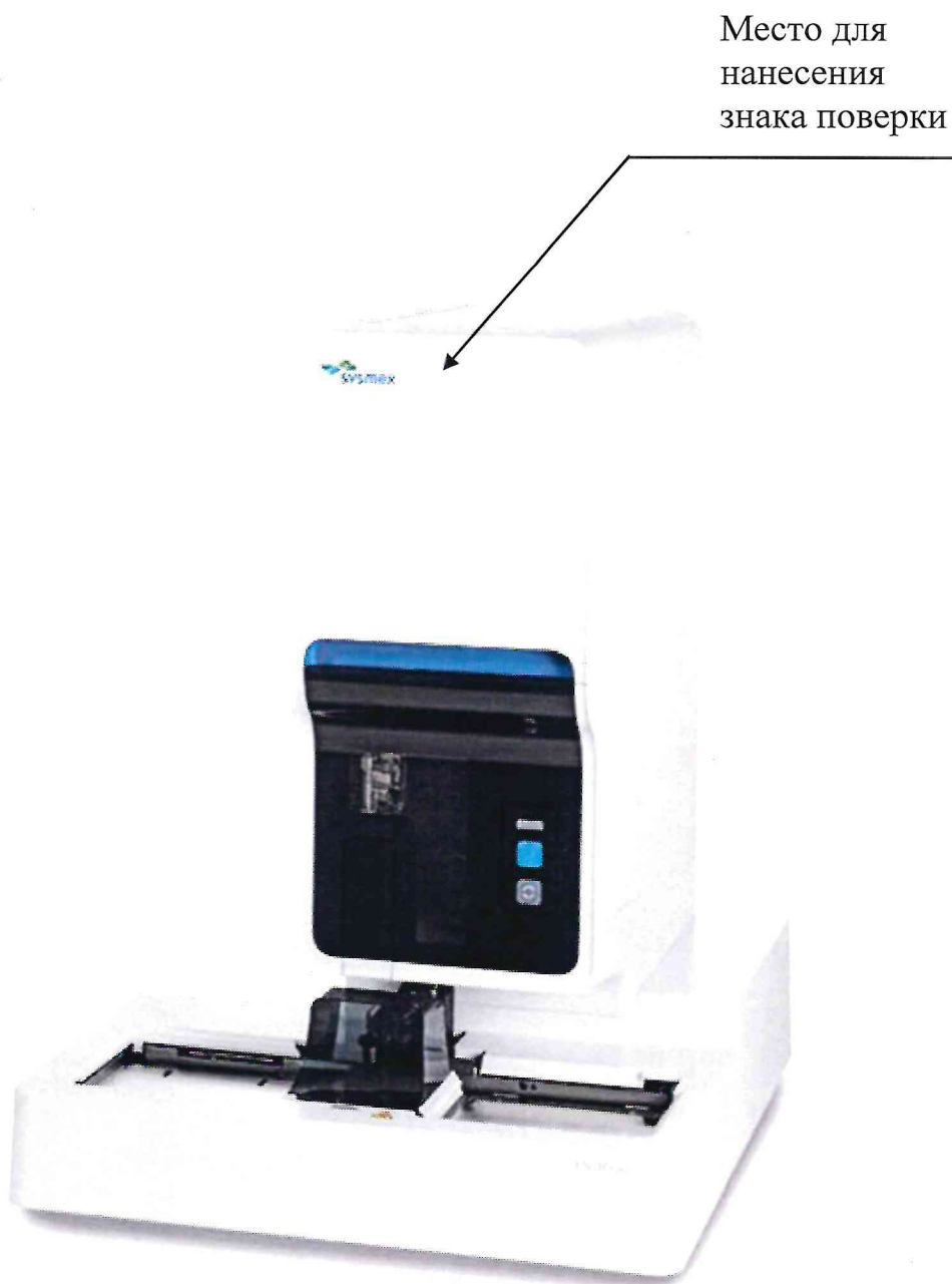
Рисунок 2.1 – Схема с указанием места для нанесения знака поверки на анализатор автоматический гематологический XN-1000 № 39749
