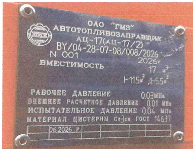
Рис.2 Табличка с данными согласно ДОПОГ
