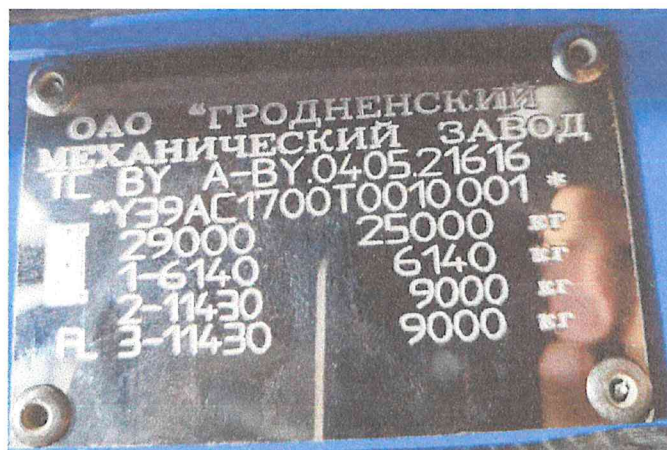
Рис.3 Табличка изготовителя в кабине водителя
