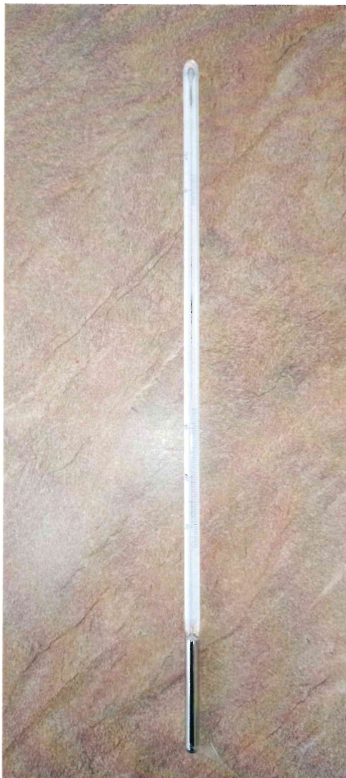
Рисунок 1.1 – Фотография общего вида термометра стеклянного ASTM 127C-86/IP99C № 0433359
