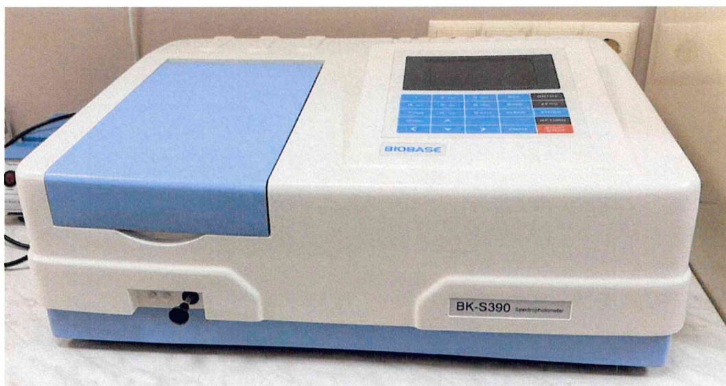
Рисунок 1.1 – Фотография общего вида спектрофотометра BK-S390 № URI24M0008
