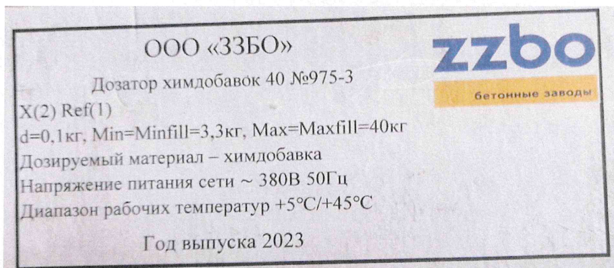
Рисунок 1.2 – Фотография маркировки дозатора химдобавок 40 № 975-3
