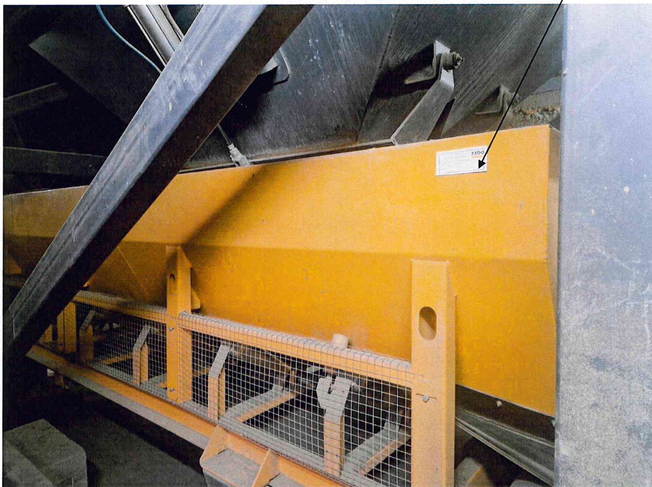
Рисунок 2 – Схема с указанием места для нанесения знака поверки на дозирующий комплекс ДКМ-40 № 955
