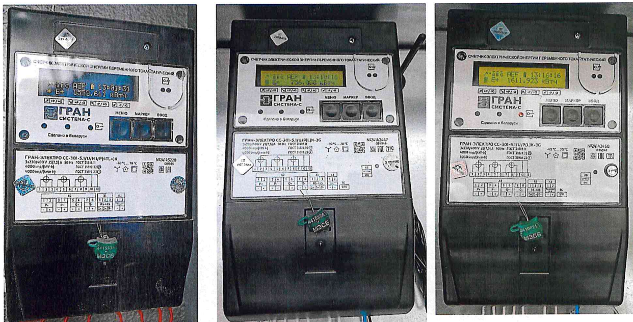
Рисунок 1.2 – Фотографии счётчиков, входящих в состав измерительных каналов АСКУЭ (изображения носят иллюстративный характер)
