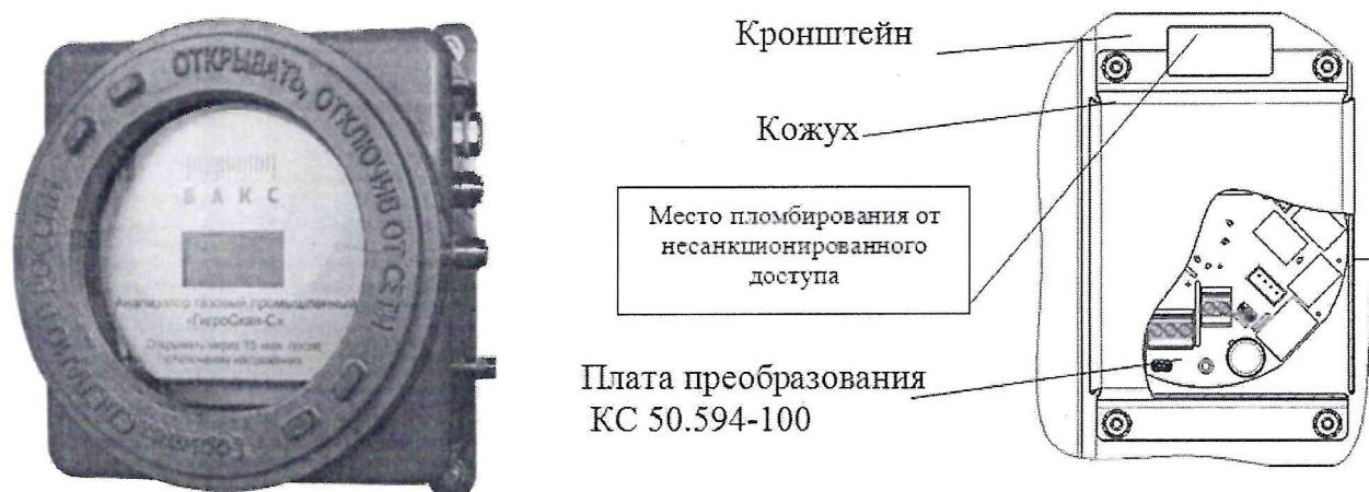
Рисунок 1 - Общий вид анализатора «ГигроСкан-С» КС 50.591-000 и схема пломбировки от несанкционированного доступа
