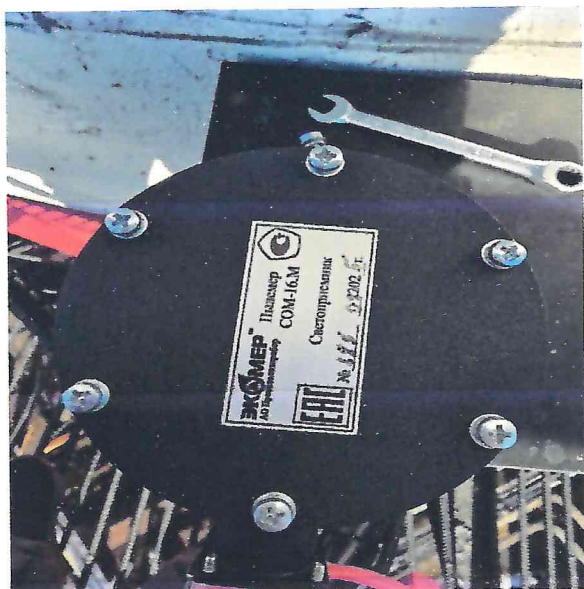
Рисунок 1.3 – Фотографии блоков источника и приемника пылемера COM-16.M (Система автоматизированная контроля выбросов загрязняющих веществ № ECS-25.132-01)
