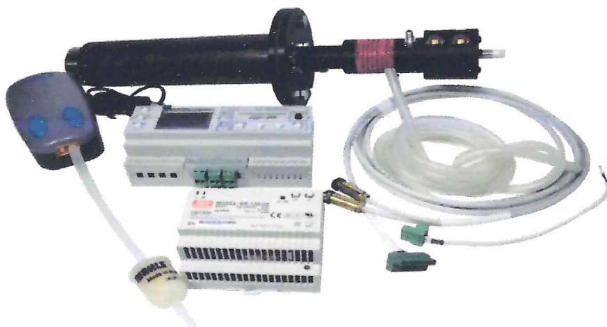
Рисунок 1.2 - Фотографии общего вида анализатор кислорода ТДК-3М (Система автоматизированная контроля выбросов загрязняющих веществ № ECS-25.132-01)
