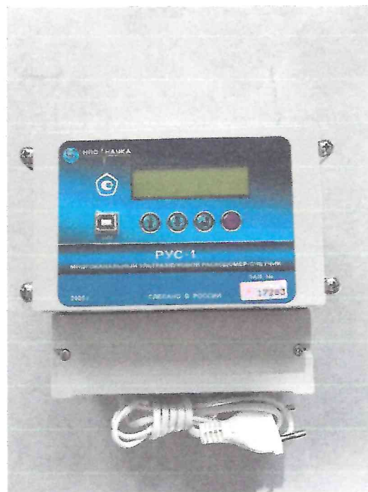
Рисунок 1.2 – Фотография общего вида первичного преобразователя расхода (УПР) расходомера-счетчика ультразвукового РУС-1 № 17283
