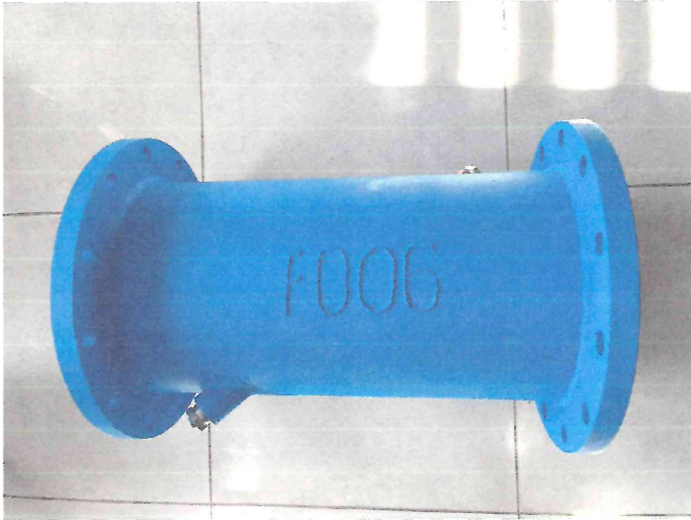
Рисунок 1.2 – Фотография общего вида первичного преобразователя расхода (УПР) расходомера-счетчика ультразвукового РУС-1 № 17283
