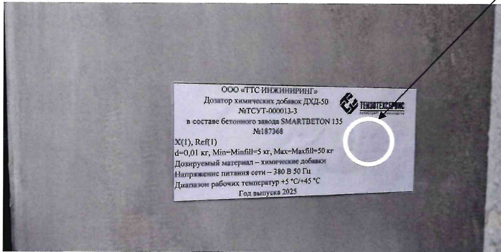
Рисунок 2.1 - Фотография с указанием места нанесения знака поверки (наклейки) на маркировочную табличку дозатора химических добавок ДХД-50 № ТСУТ-000013-3 в составе бетонного завода SMARTBETON 135 № 187368
