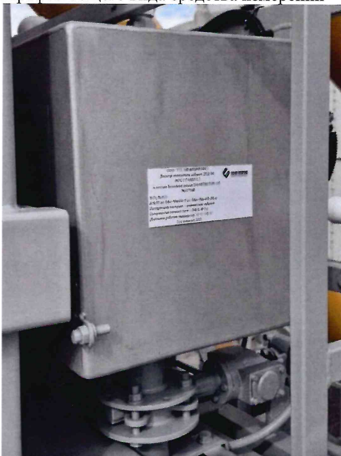
Рисунок 1.1 – Фотография внешнего вида дозатора химических добавок ДХД-50 № ТСУТ-000013-3 в составе бетонного завода SMARTBETON 135 № 187368
