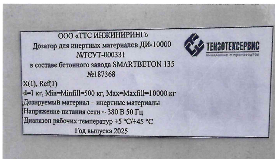
Рисунок 1.2 – Фотография маркировки дозатора для инертных материалов ДИ-10000 № ТСУТ-000331 в составе бетонного завода SMARTBETON 135 № 187368
