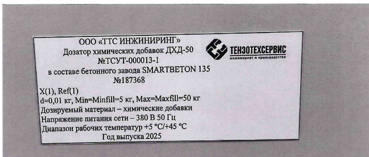
Рисунок 1.2 – Фотография маркировки дозатора химических добавок ДХД-50 № ТСУТ-000013-1 в составе бетонного завода SMARTBETON 135 № 187368
