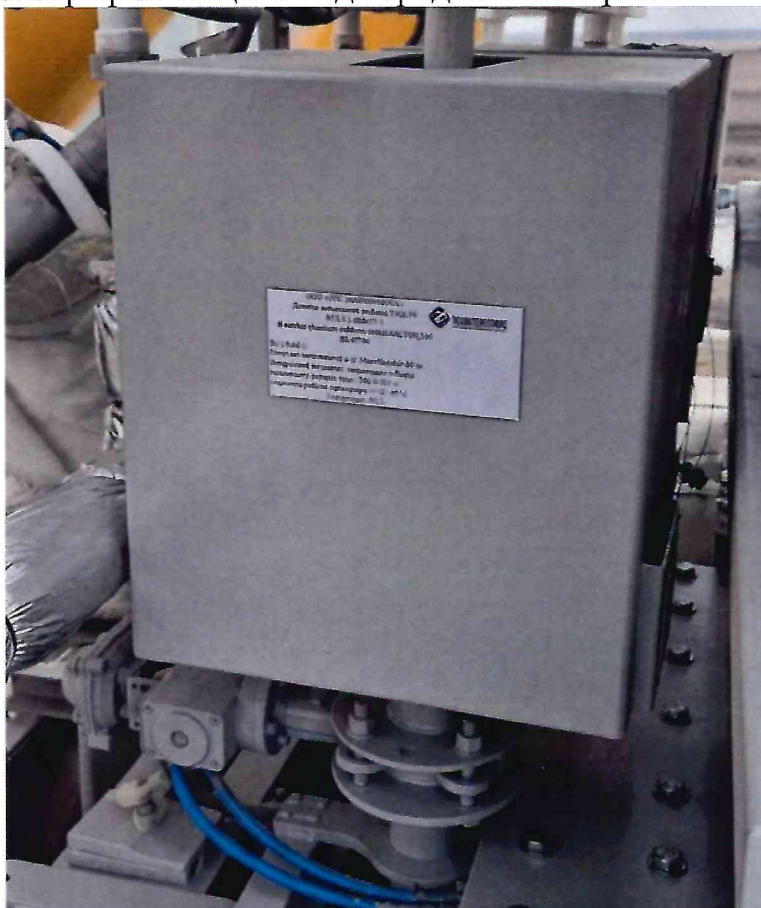
Рисунок 1.1 – Фотография внешнего вида дозатора химических добавок ДХД-50 № ТСУТ-000013-1 в составе бетонного завода SMARTBETON 135 № 187368
