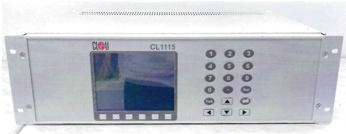
Рисунок 1.1 – Фотография общего вида счётчика электрической энергии однофазного эталонного CL1115 № 20241945
