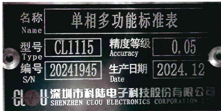
Рисунок 1.2 – Фотография маркировки счётчика электрической энергии однофазного эталонного CL1115 № 20241945
