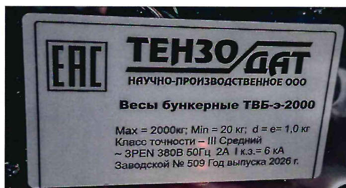
Рисунок 1.2 – Фотография маркировки весов бункерных ТВБ-э-2000 № 509
