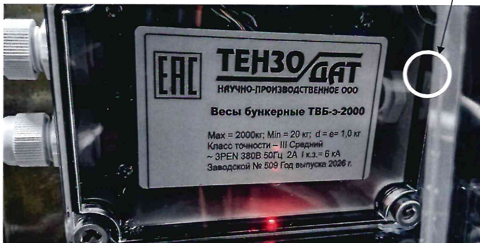
Рисунок 2.1 - Фотография с указанием места нанесения знака поверки (наклейки) на корпус ПТН весов бункерных ТВБ-э-2000 № 509.
