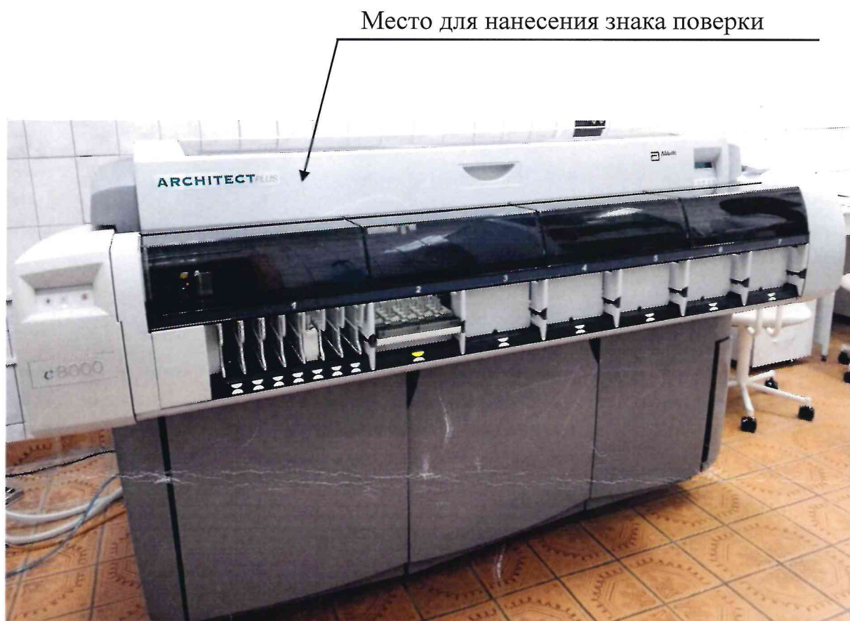
Рисунок 2 – Схема с указанием места для нанесения знака поверки на анализатор биохимический автоматический: анализатор биохимический модульный ARCHITECT с принадлежностями: модель c8000 с принадлежностями № С804863
