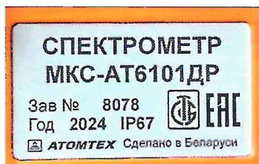
а) маркировочная табличка на устройстве детектирования
