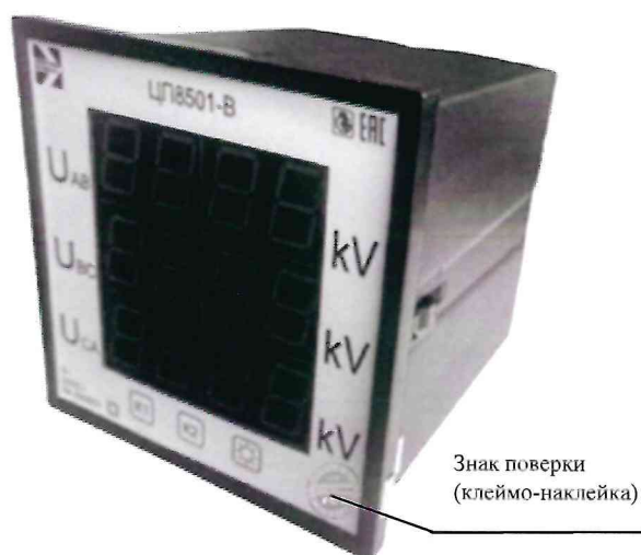
Рисунок 2.1 – Схема с указанием места для нанесения знака поверки на двухканальные и трехканальные устройства с габаритными размерами лицевой панели 120x120 mm и 96x96 mm
