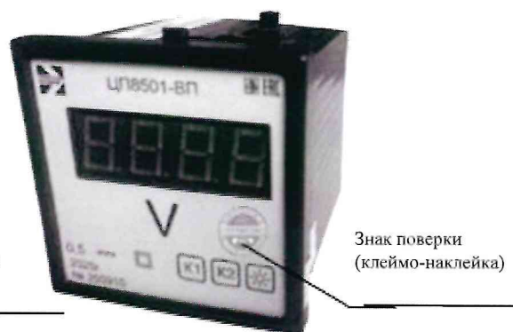
Рисунок 2.4 – Схема с указанием места для нанесения знака поверки на устройства с габаритными размерами лицевой панели 72x72 mm
