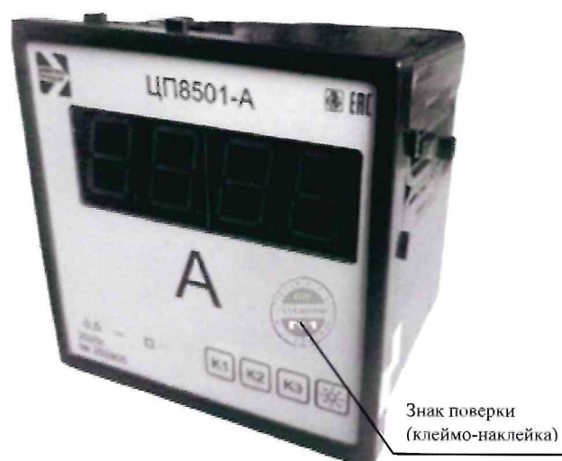
Рисунок 2.2 – Схема с указанием места для нанесения знака поверки на одноканальные устройства с габаритными размерами лицевой панели 120x120 mm и 96x96 mm
