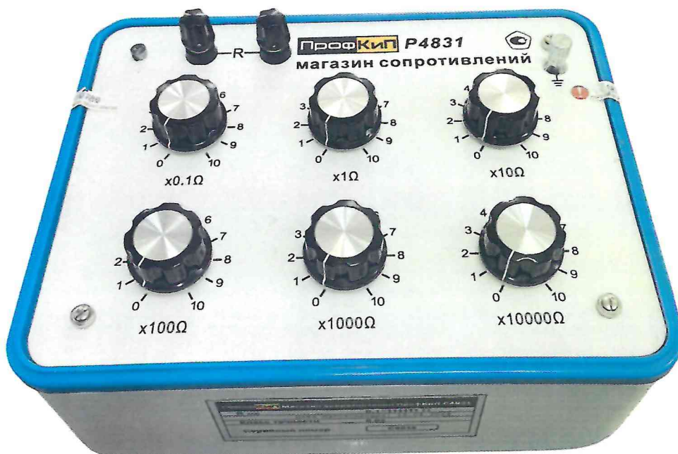
Рисунок 1.1 – Фотография общего вида магазина сопротивлений ПрофКип R4831 № С6035
