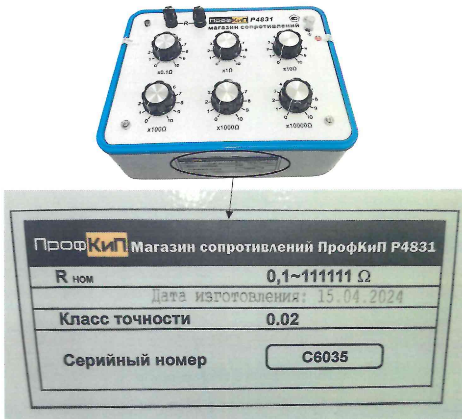
Рисунок 1.2 – Фотография маркировки магазина сопротивлений ПрофКип R4831 № С6035
