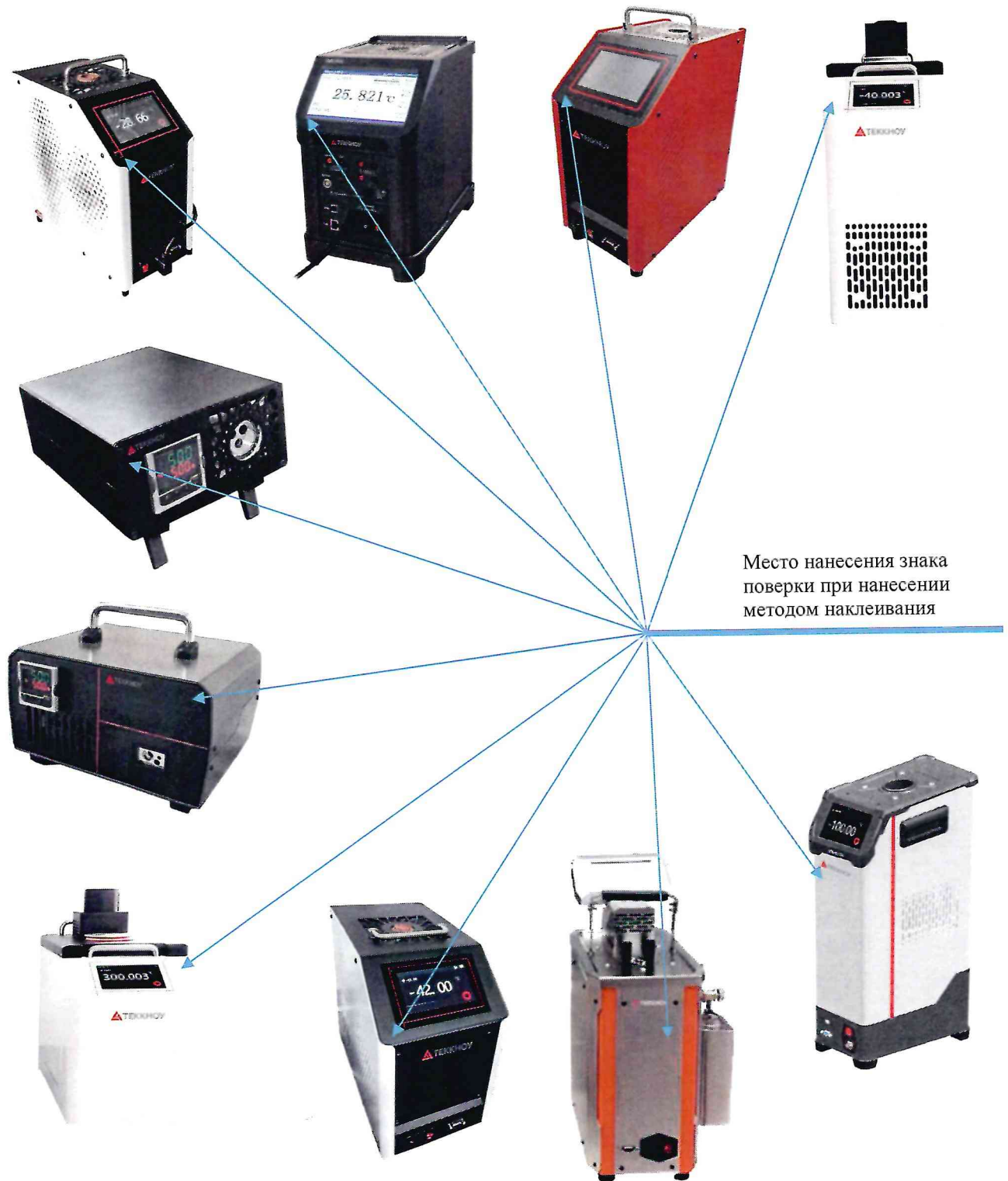
Рисунок 2.1 – Схема (рисунок) с указанием места для нанесения знака поверки на калибраторы температуры ТКх-Теккноу
