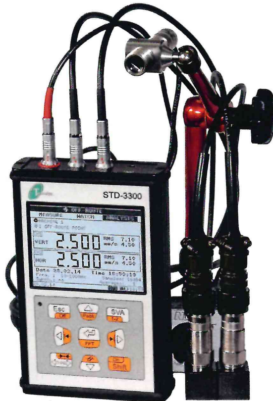
Рисунок 1.1 – Фотография общего вида виброанализатора STD-3300 (изображение носит иллюстративный характер)
