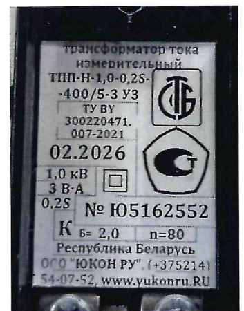
Рисунок 1.2 – Фотографии маркировки трансформаторов тока измерительных ТПП и ТПП-Н (изображение носит иллюстративный характер)
