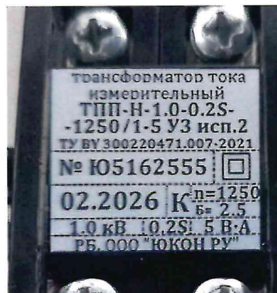
Рисунок 1.2 – Фотографии маркировки трансформаторов тока измерительных ТПП и ТПП-Н (изображение носит иллюстративный характер)
