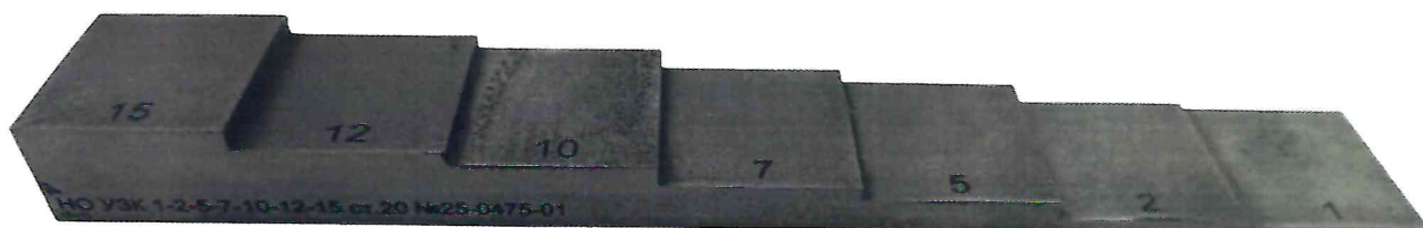
Рисунок 1.1 – Фотография общего вида Настроечный образец НО УЗК – стандартный образец предприятия типа «Ступенька» № 25-0475-01
