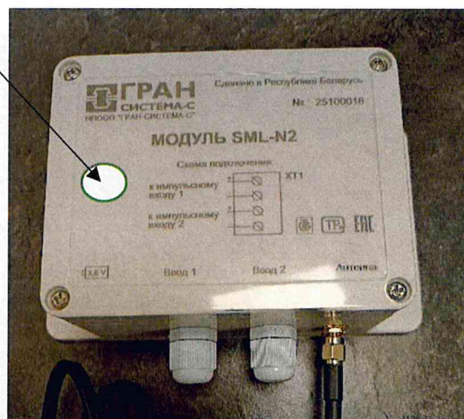
Рисунок 2.1 – Схема (рисунок) с указанием места для нанесения знака поверки средств измерений
