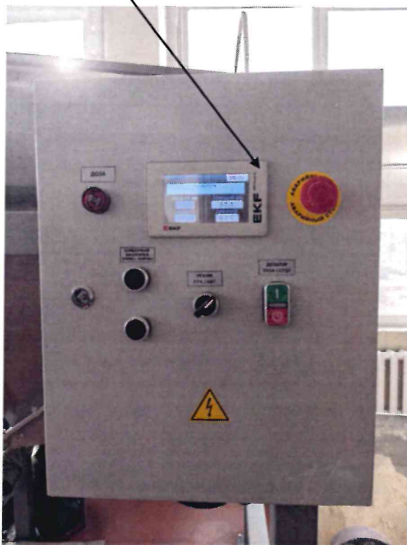
Рисунок 2.1 – Схема с указанием места для нанесения знака поверки установки подготовки компонентов ДЭА-300-Ж-1 № 001
