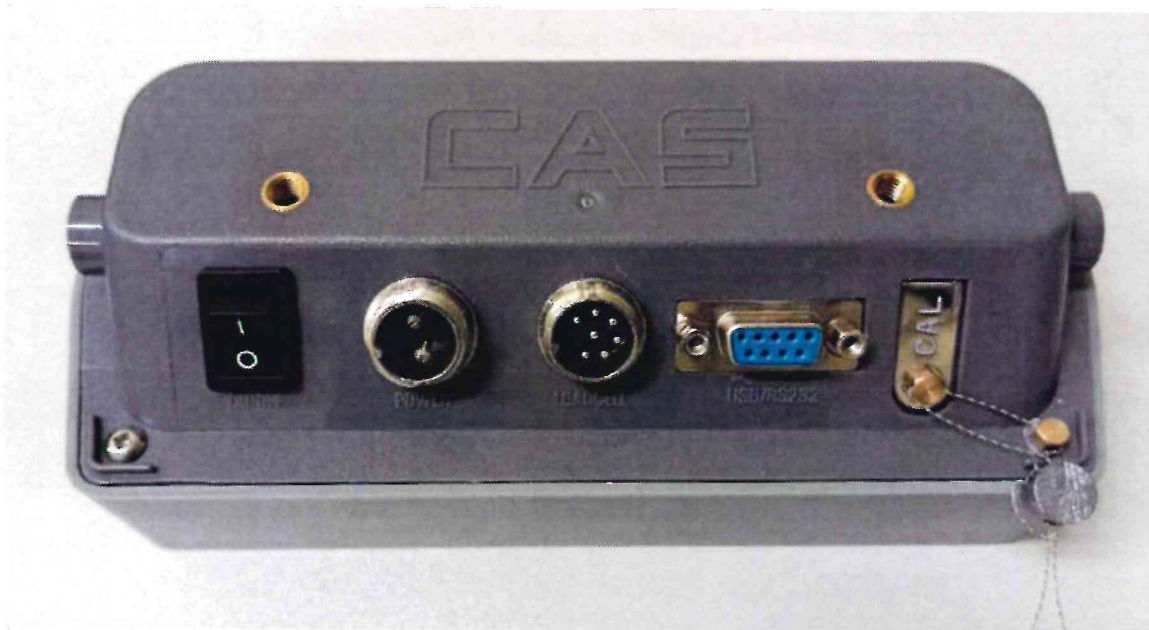
Рисунок 3.1 – Схема с указанием места для нанесения свинцовой пломбы на весовой преобразователь СИ-2001А установки подготовки компонентов ДЭА-300-Ж-1 № 001
