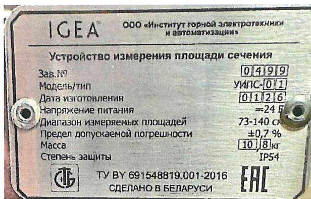
Рисунок 1.3 – Образец маркировочной таблички УИПС (изображение носит иллюстративный характер)
