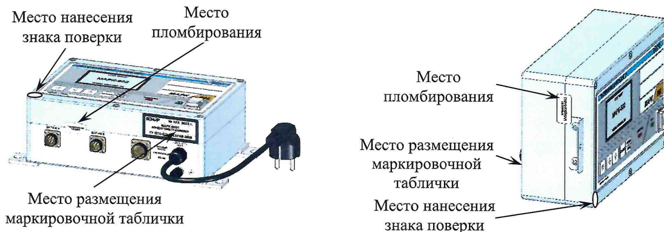
б – Схема пломбирования от несанкционированного доступа к элементам конструкции (наклейка изготовителя), обозначение места нанесения знака поверки, место установки маркировочной таблички на корпусе
