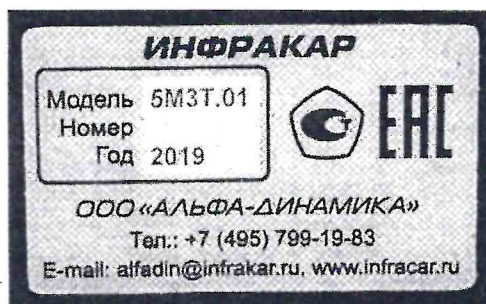
Рисунок 11 – Общий вид типовой идентификационной таблички и место нанесения знака утверждения типа для газоанализаторов производства ООО «Альфа-динамика»
