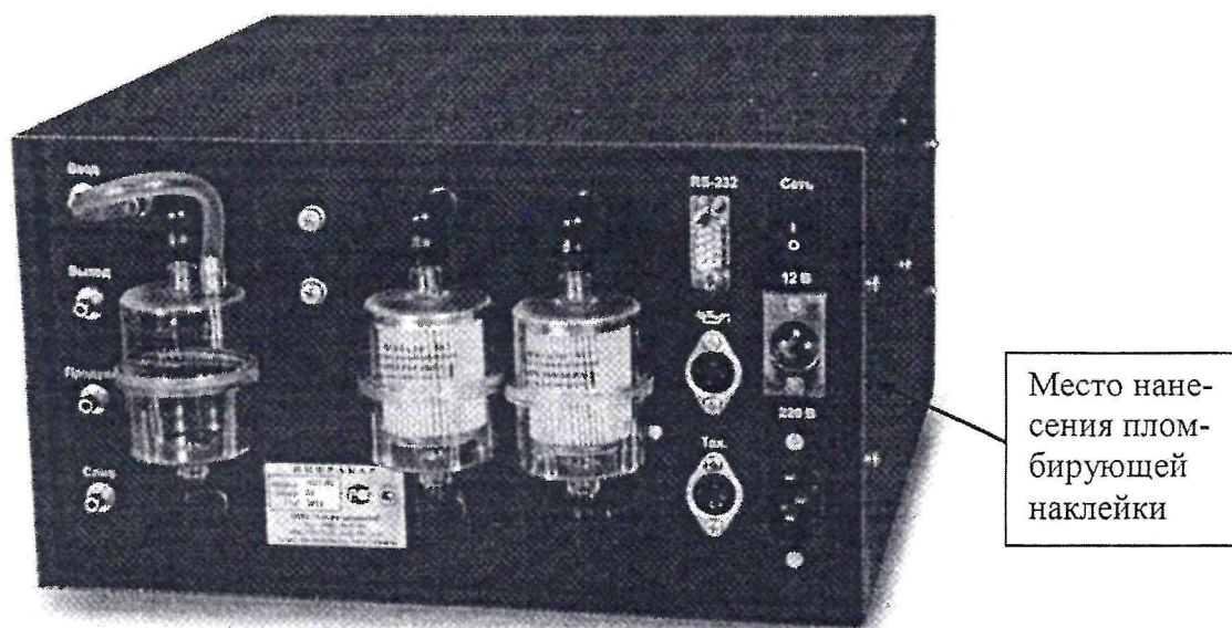
Рисунок 6 – Общий вид газоанализаторов ИНФРАКАР с двумя фильтрами (вид сзади)
