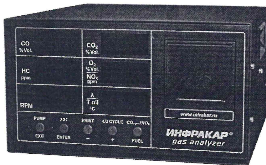
Рисунок 4 – Общий вид газоанализаторов ИНФРАКАР в экспортном исполнении (вид спереди)
