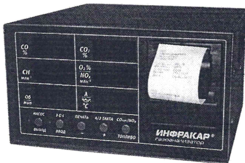
Рисунок 3 – Общий вид газоанализаторов ИНФРАКАР с принтером (вид спереди)
