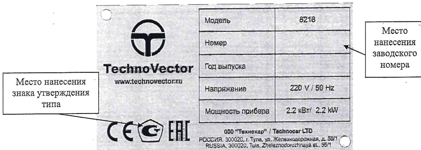
Рисунок 11 – Общий вид типовой маркировочной таблички с указанием места нанесения знака утверждения типа, места нанесения серийного номера
