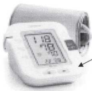
Рисунок А.2 Внешний вид измерителя M6 Comfort/HBM-7000-E и место нанесения поверительного клейма-наклейки
