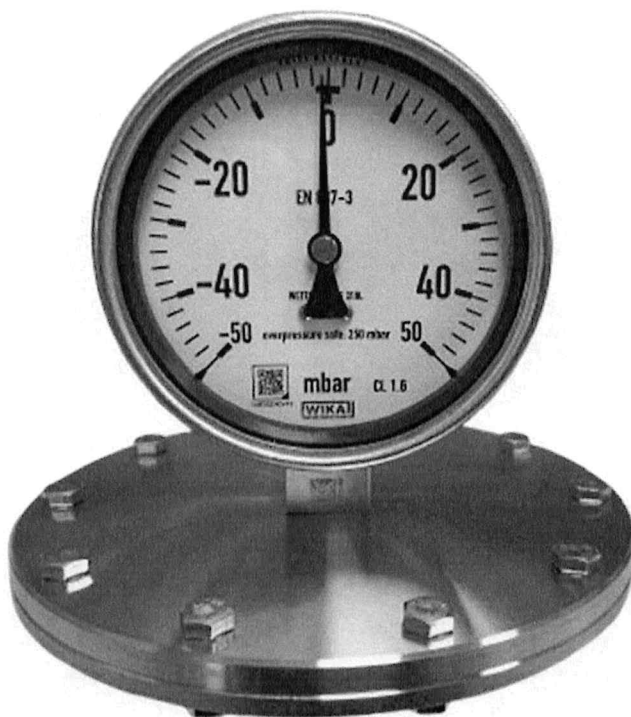
Рисунок 1.1 – Фотография общего вида манометра WIKА 432.50.100 № 1А03QZNOV49
