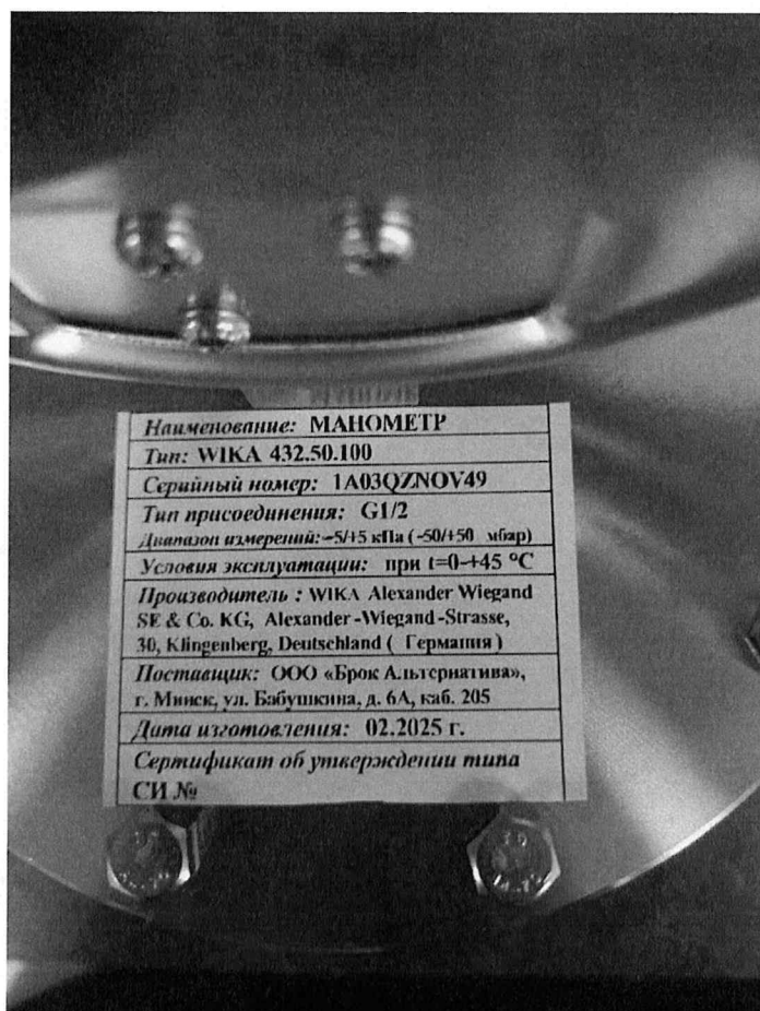
Рисунок 1.2 – Маркировка манометра WIKА 432.50.100 № 1А03QZNOV49
