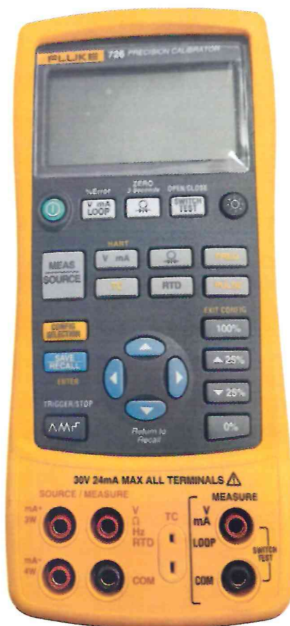
Рисунок 1.1 – Фотография общего вида калибратора процессов многофункционального Fluke 726 № 4078371
