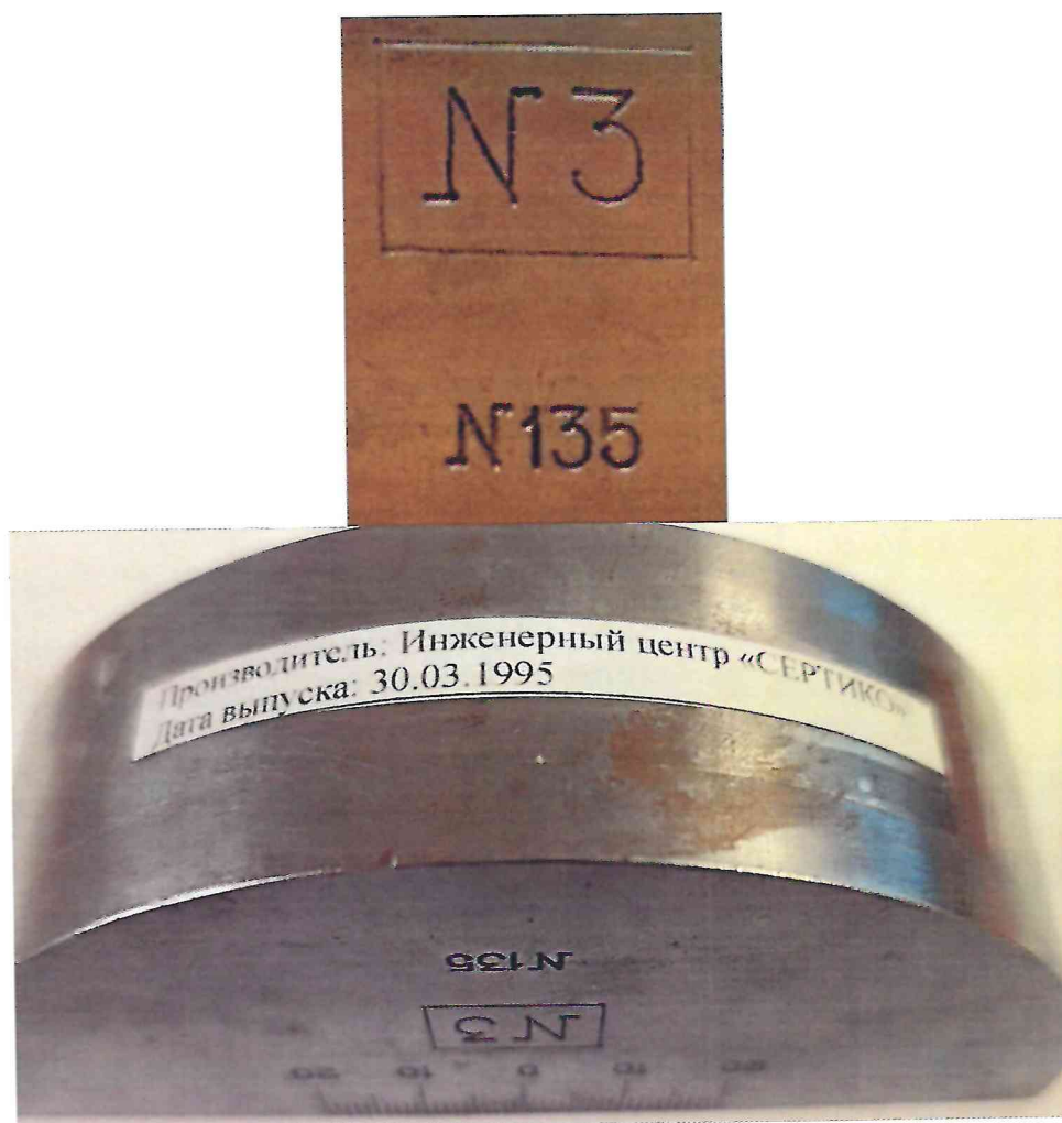
Рисунок 1.2 – Фотография маркировки контрольного образца № 3 из комплекта КОУ-2 № 135
