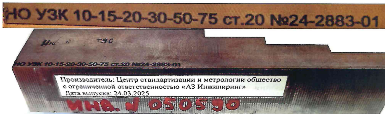
Рисунок 1.2 – Фотография маркировки Настрочного образца НО УЗК – стандартный образец предприятия типа «Ступенька» № 24-2883-01
