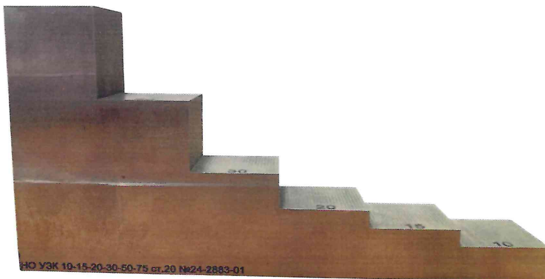
Рисунок 1.1 – Фотографии общего вида Настрочный образец НО УЗК – стандартный образец предприятия типа «Ступенька» № 24-2883-01
