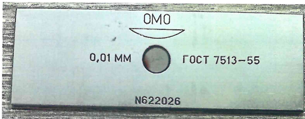
Рисунок 1.1 – Фотография общего вида и маркировки объект-микроскопа отраженного света ОМО № 622026
