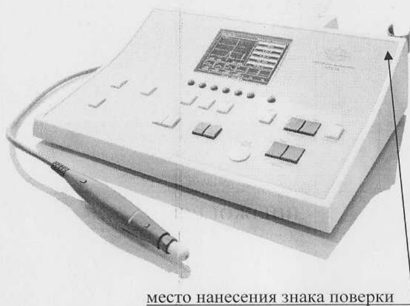
Рисунок 1 - Место нанесения знака поверки на аудиометр импедансный АТ 235
