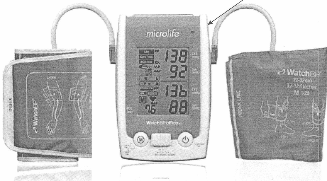
Рисунок А.2 Внешний вид измерителя Watch BP Office AFIB и место нанесения знака поверки
