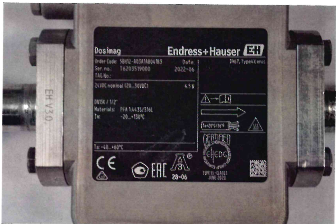
Рисунок 1.2 – Фотография маркировки расходомера электромагнитного Dosimag № T6203519000
