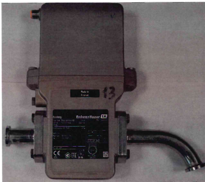
Рисунок 1.1 – Фотография общего вида расходомера электромагнитного Dosimag № T6203319000
